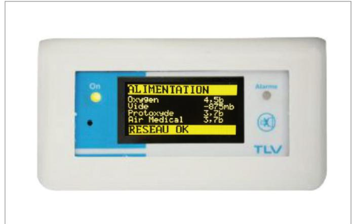
Lo schermo OLED di riporto SEC MIR raggruppa tutte le informazioni e gli allarmi di centrale. Con una spesa minore rispetto ad un allarme « specchio » il modulo di riporto a schermo OLED permette di visualizzare le stesse informazioni con un ingombro ridotto. Realizzato secondo le misure MOSAIC 45 dei moduli permette un'installazione facilitata sia da incasso che per esterno.
