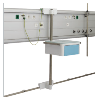
Carrello scorrevole SM 60, Ø38, Mono-tubo, ripiano non incluso, per rail orizzontali (trave / parete)
