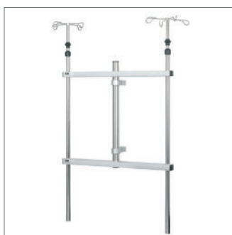
Set di 2 aste, telescopiche, a 4 ganci, per carrello mono-tubo diam. mm 38, portate max totale 2 x 32 kg, 2 kg/gancio
