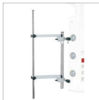
Tubo inox secondario, diam 25 x h.1000 mm, su braccetti a sbalzo da 300 mm, portata max. 28 kg
